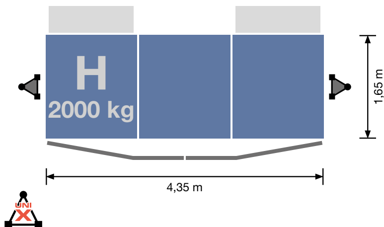
GEDA 1500 Z/ZP platforma H 2 x drzwi załadunkowe / 2 rampy wyladowcze
